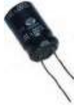
चित्र. 1.18: कैपेसिटर का समाई मान 4700 माइक्रो फ़ैराड और अधिकतम वोल्टेज मान 10 V - दिखा रहा है
