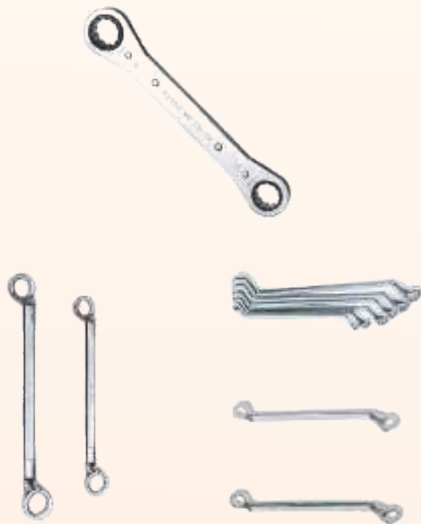
Fig: Ring Spanner close type
