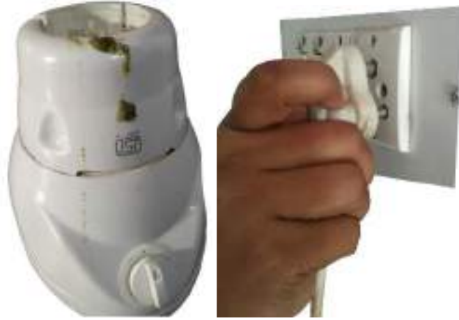
चित्र3.42 (ए) गंदा बेस यूनिट (बी) बेस यूनिट के पावर कॉर्ड को अनप्लग करना
