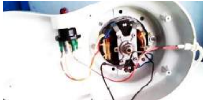
चित्र 3.115 मिक्सर की वायरिंग का निरीक्षण करें
