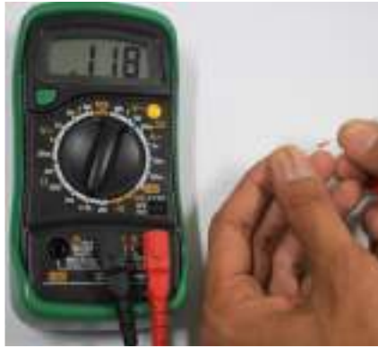
चित्र 2.3 लाल और काले प्रोब के रेजिस्टर टर्मिनल को छूकर रेजिस्टर के प्रतिरोध को मापना
