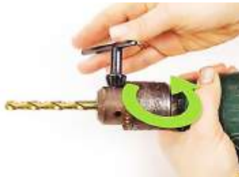
चित्र 2.26 'की' को क्लॉकवाइज दिशा में घुमाएँ, सौजन्य: http://bit.ly/2KBzwnwG
