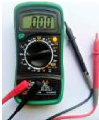
चित्र 2.11 करंट को मापने के लिए मल्टीमीटर सेट करें
