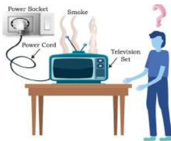
चित्र 1.1 टेलीविजन सेट में ओवर करंट के कारण जलना
