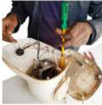
चित्र .3.134 इलेक्ट्रिक मोटर पुनः असेंबल करना
