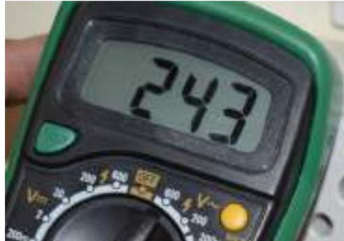
चित्र 2.9 होल्ड बटन का उपयोग करके डिस्प्ले में वैल्यू को होल्ड करना
