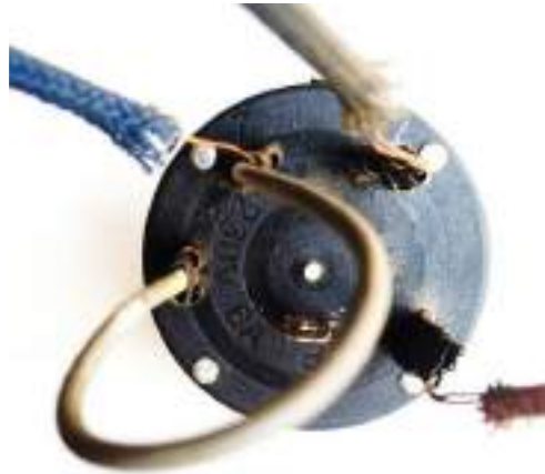
चित्र 3.138 एक इलेक्ट्रिक मिक्सर का रोटरी स्विच
