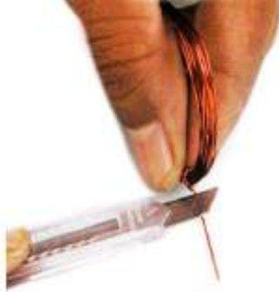
चित्र 1.50 इन्सुलेशन कोटिंग को हटाना
