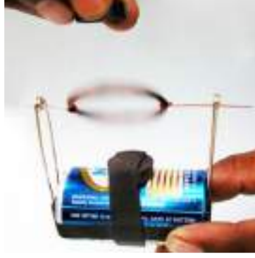
चित्र 1.52 कॉइल के शीर्ष पर एक और चुंबक पकड़कर रखें और गति में परिवर्तन देखें।
