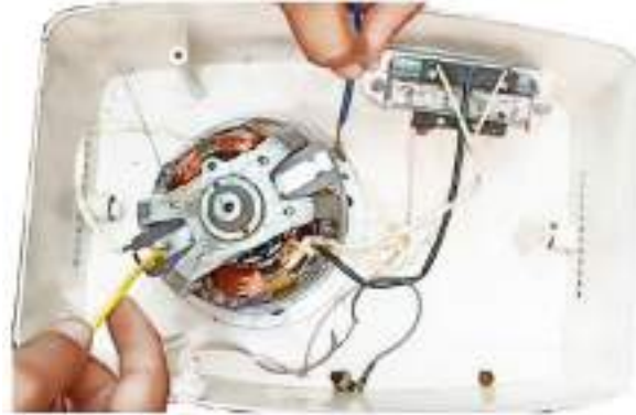
चित्र 3.125 मोटर की वाइंडिंग का परीक्षण
