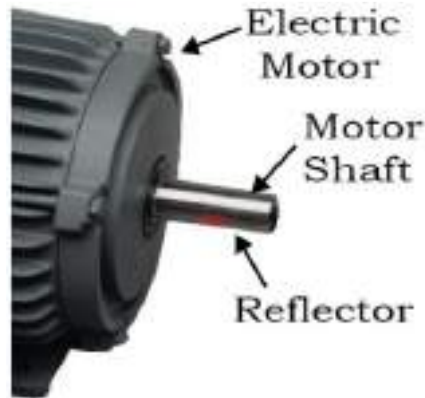
चित्र 1.42 मोटर शाफ्ट पर रिफ्लेक्टिंग टेप
