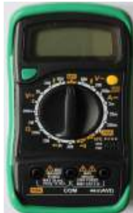
चित्र 2.10 आप या तो 10 ए को मापने के लिए चिह्नित टर्मिनल चुनें या 200 मिली एंपीयर को मापने के लिए चिह्नित टर्मिनल चुनें
