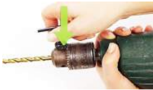
चित्र 2.25: चक को ढीला करने के लिए 'की' लगाना, सौजन्य: http://bit.ly/2KBzwnwG
