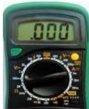
चित्र 2.15 मान को स्थिर करने के लिए होल्ड बटन का उपयोग किया जा सकता है
