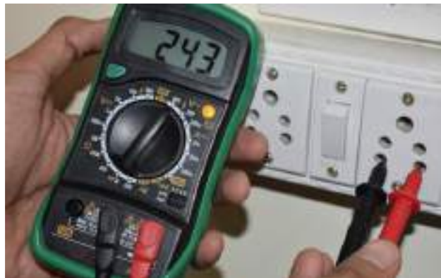
चित्र 2.7 मल्टीमीटर का उपयोग करके एसी वोल्टेज को मापना
