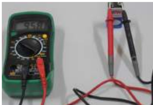
चित्र 2.8 मल्टीमीटर का उपयोग करके डीसी वोल्टेज को मापना
