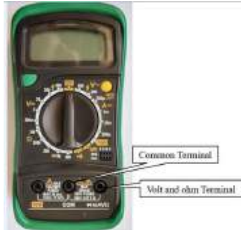
चित्र 2.1 (क) वोल्ट ओम टर्मिनल और मल्टीमीटर का आम टर्मिनल
