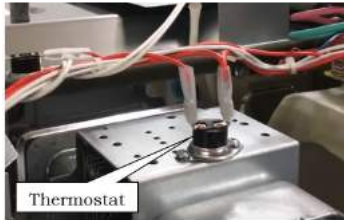
चित्र .4.21 मैग्नेट्रॉन पर थर्मोस्टैट
