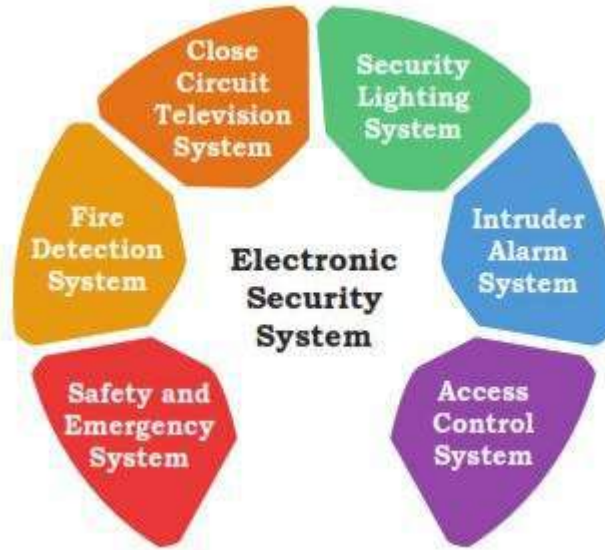
चित्र 3.5: इलेक्ट्रॉनिक सुरक्षा प्रणाली के घटक
