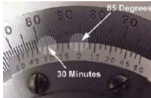
चित्र. 4.16: हमेशा वर्नियर को उसी दिशा में पढ़ें जिस दिशा में आप डायल को पढ़ते हैं मिनट की इस संख्या को पूरे डिग्री की संख्या में जोड़ें। चित्र.4.16 में डिग्री और मिनट की कुल संख्या 85 डिग्री और 30 मिनट के बराबर होगी। सही वर्नियर बेवल प्रोट्रेक्टर रीडिंग प्राप्त करने के लिए आकृति में माप देखें।
