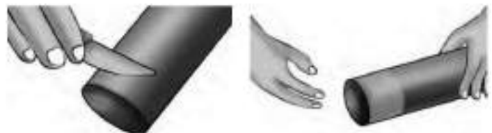
चित्र 1.11 : दोनों किनारों पर विलायक (solvent) लगाएं
