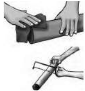
चित्र 1.10 : पाइप के किनारों को काटें और साफ करें
