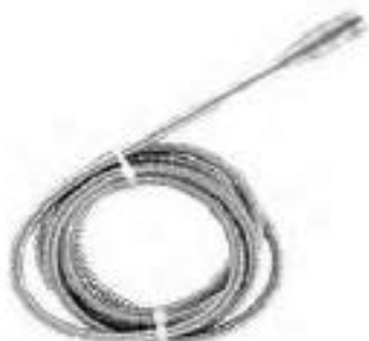
चित्र 5.13 : क्लॉग्स हटाने के लिए टूलों का उपयोग
