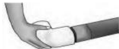
चित्र 1.12 : जब सीमेंट विलायक (solvent) गीला हो तभी किनारों को
