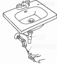
चित्र 5.12: पी- ट्रेप आगे निकासी और सिंक ड्रेन लाइन रुकावट को साफ करना
