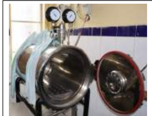
चित्र 2.1 : विसंक्रमण के लिए इस्तेमाल की जाने वाली ऑटोक्लेव मशीन
