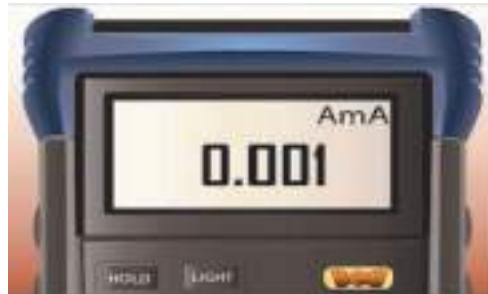
चित्र.3.15 होल्ड बटन का उपयोग मूल्य को स्थिर करने के लिए किया जा सकता है
