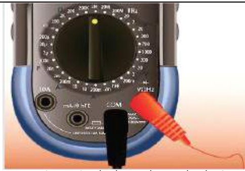
चित्र 3.6 (बी) एसी वोल्टेज को मापने के लिए नॉब को चालू करना
