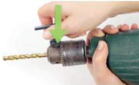
चित्र 3.25 बिट को ढीला करने के लिए चंक को काउंटर क्लॉकवाइज घुमाएं
