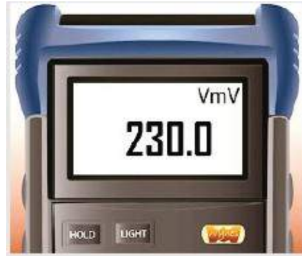
चित्र.3.9 होल्ड बटन का उपयोग करके डिस्प्ले में मान को होल्ड करना
