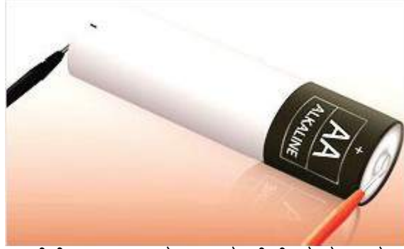
चित्र.3.8 मल्टीमीटर का उपयोग करके डीसी वोल्टेज को मापना
