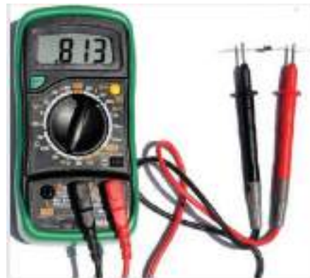
चित्र.2.38 (ए) डायोड मोड में मल्टीमीटर जो डायोड में आगे के बायस को दिखाता है
