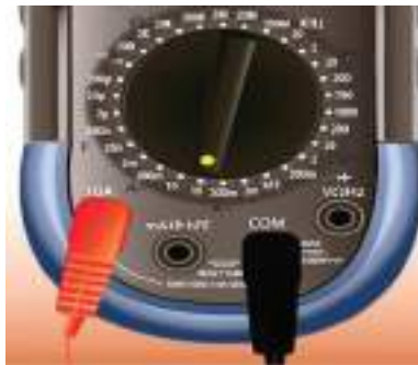
चित्र 3.10 इसमें 10 एम्पीयर को मापने के लिए चिह्नित टर्मिनल चुनें या 200 मिली एम्पीयर को मापने के लिए चिह्नित टर्मिनल चुनें
