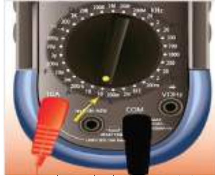
चित्र.3.11 करंट को मापने के लिए मल्टीमीटर सेट करें
