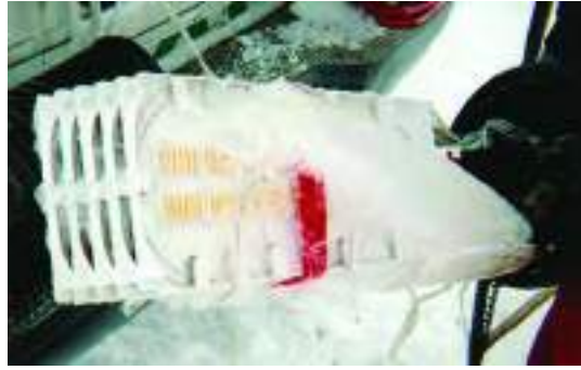
चित्र 5.6: आइस क्रश के कारण फाइबर केबल को क्षति
