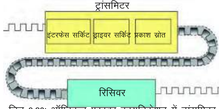
चित्र 3.20: ऑप्टिकल फाइबर कम्युनिकेशन में ट्रांसमिटर
