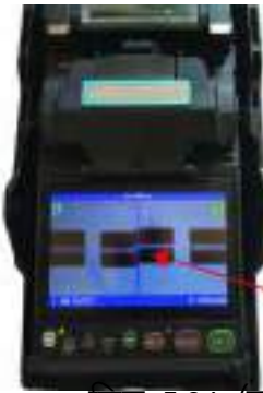
चित्र 5.34 (ख): फाइबर के कोर-टू-कोर एलाइनमेंट का एलसीडी डिसप्ले
