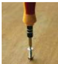
चित्र 4.2: पेचकश की नोक को पेच के सिर पर रखा जाता है
