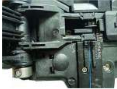
चित्र 5.23 (क): फाइबर को क्लीवर में रखें और ब्लेडों को समायोजित करें
