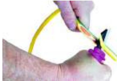
चित्र 4.9: केबल काटने वाले चाकू का इस्तेमाल करते हुए केबल का इन्सुलेशन हटाना
