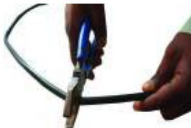
चित्र 5.8: प्लायर का प्रयोग करते हुए क्षतिग्रस्त फाइबर को काटना
