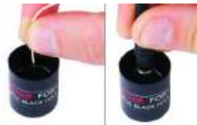
चित्र 4.30: इंडेक्स के मिलान के लिए मिलान जेल
