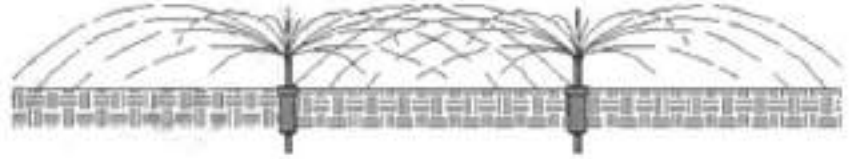
चित्र 3.1 : ओवरलैपिंग सिंक्रलर स्प्रे का योजनाबद्ध (Schematic) स्केच
